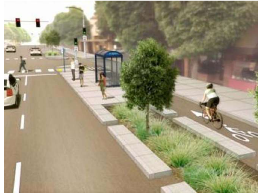
Şekil 1.30 Yağmur suyunun yüzey akışına geçmesine engel olan yeşil bant örneği (URL 14).
