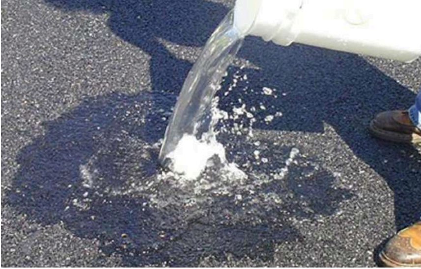
Şekil 1.32 Geçirimli beton yüzey (URL 16).
